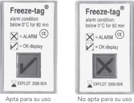
Figura 6: Monitor de congelamiento
